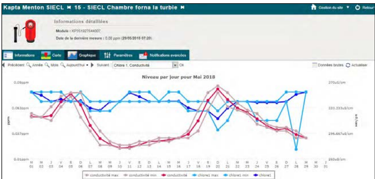
Mesure du Chlore et de la Conductivité dans la Chambre de la Forna
