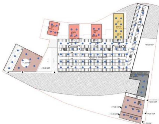
Carte n°8 – Principe d'implantation des sondes verticales au droit du site (Source : CARF ; plan masse du projet)
